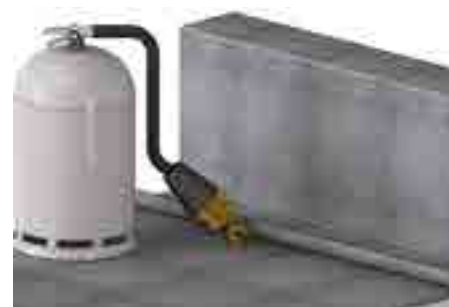
3. Завести первый слой гидроизоляции на вертикальную поверхность в соответствии с рисунком
