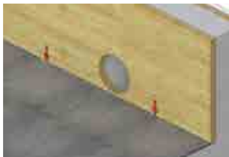
2. Уложить первый слой битумной гидроизоляции
